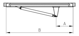
Zulässige Fenstergrößen und -gewichte sind in Abhängigkeit von Scharnierposition und Beschlagsanordnung begrenzt. Die einwandfreie Funktion der Öffnung muss durch Versuche überprüft werden.
